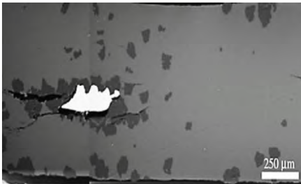
شکل ۱۲- نمونه‌ی ۵% SS Mg با اکتیواسیون بالای ۱ wt% H کونچ شده است. تصویر میکروسکوپ الکترونی روبشی به وسیله‌ی سیگنال الکترون‌های برگشتی برای تصویربرداری استفاده شده است [۳۵].
