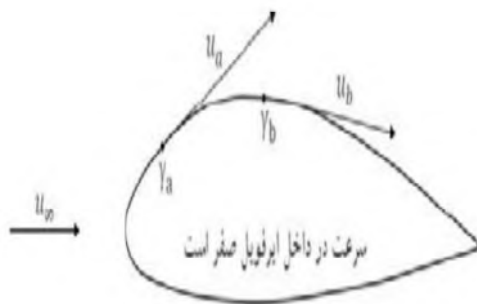
شکل ۵. ایرفویل به صورت یک جسم صلب، با سرعت صفر در داخل مقطع
