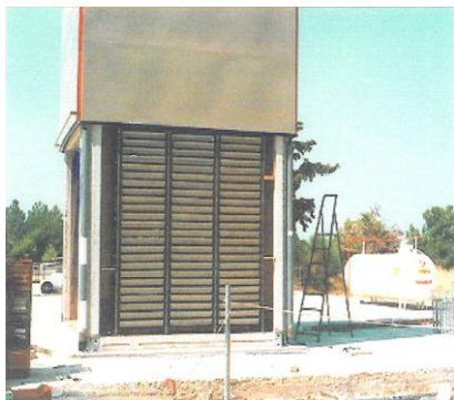
شکل ۱۶ شمای کلی یک خشک کن هیبریدی (سوخت بیوگاز)
