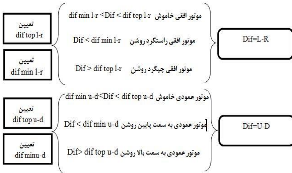
شکل ۹ شرایط روشن و خاموش بودن موتورها و جهت چرخش آن‌ها
