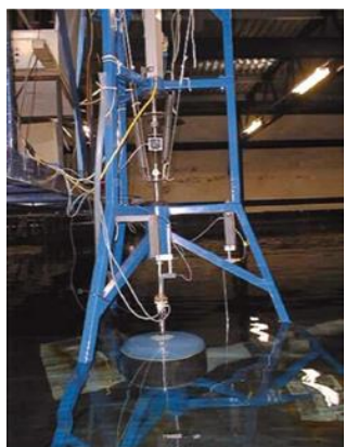
شکل ۸ نمونه مبدل نوسانگر موج ارشمیدس در مقیاس ۱:۵۰ در سال ۱۹۹۷ [۹]
