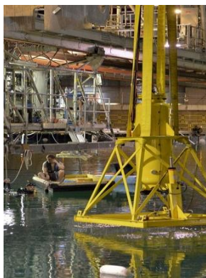
شکل ۱۴ نوسانگر موج ارشمیدس با مقیاس ۱:۲۰ در سال ۲۰۱۶ در آمریکا [۱۵]
