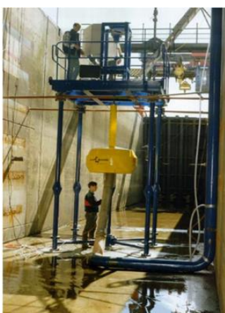
شکل ۷ نمونه مبدل نوسانگر موج ارشمیدس در مقیاس ۱:۲۰ در سال ۱۹۹۴ [۹]
