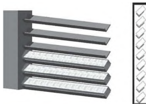
شکل ۱۲ شماتیکی از مقطع و پرسپکتیو دیوار سرمایشی (۸-۱۰)
