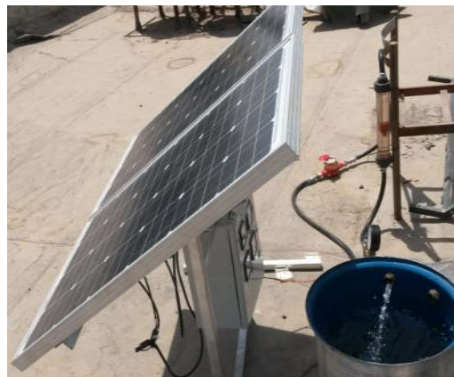
شکل ۳ نمونه ای از دستگاه آزمایش پانل های فتو ولتائیک و پمپ آب ولتائیک
