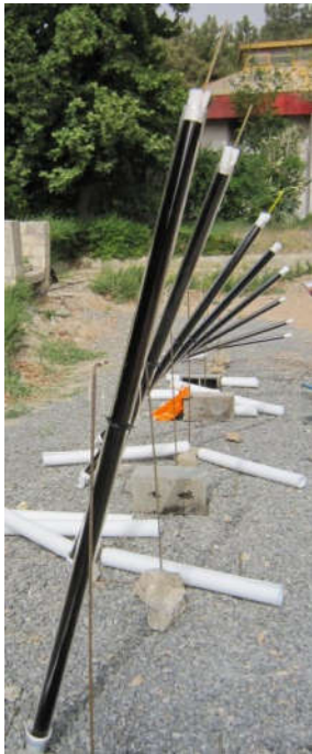
شکل ۲ آرایش کلکتورهای لوله خلاء در شیب‌های ۱۰ تا ۸۰ درجه
