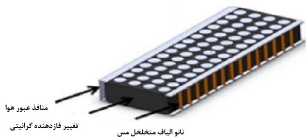
شکل 6 خنک‌کاری باتری خودرو فورد اسکپ به روش هیبرید [17]
