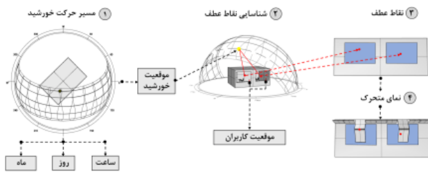
شکل 11 نحوه عملکرد نمای متحرک با توجه به نقطه‌ی جذب ایجادشده براساس مسیر حرکت خورشید و موقعیت‌های تعریفشده
