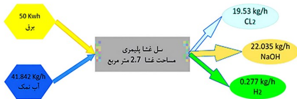
شکل 7 شماتیک ورودی و خروجی یک سلول کلر آلکالی.
