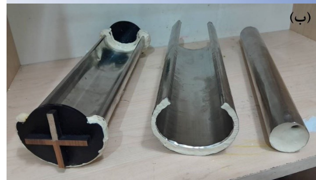
شکل 1 ساختارهای مختلف برای جاذب‌های حرارتی (الف) مدل اولیه از جاذب‌های ارائه شده. (ب) جاذب‌های ساخته شده.
