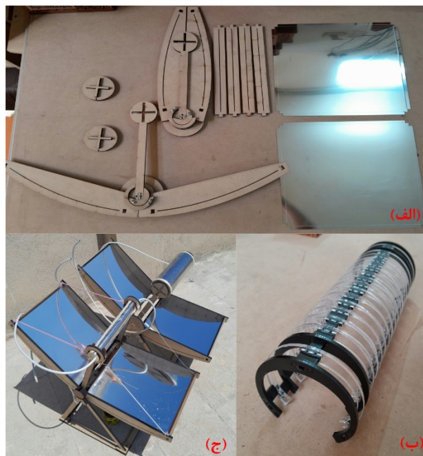
شکل 6 (الف) قطعات برش خورده با دستگاه سی ان سی، (ب) اسکلت با جنس پلکسی گلاس برای جاذب، (ج) کلکتور نهایی و مونتاژ شده.
