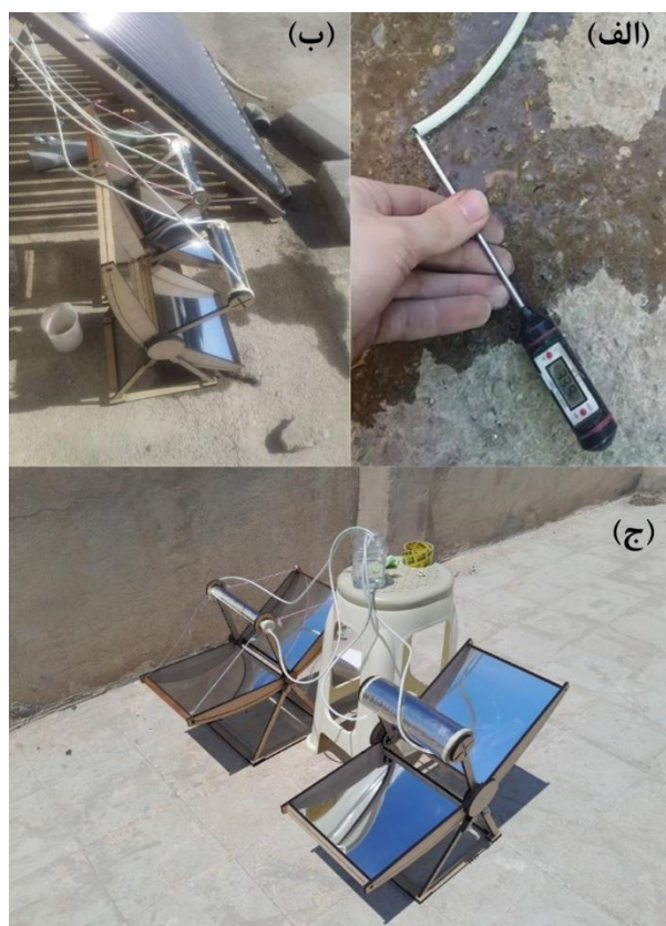
شکل 8 (الف) دماسنج ترمومتر دیجیتالی، (ب) شرایط آزمایشی برای نمونه اولیه، (ج) شرایط آزمایشی برای جاذب تاریک.
