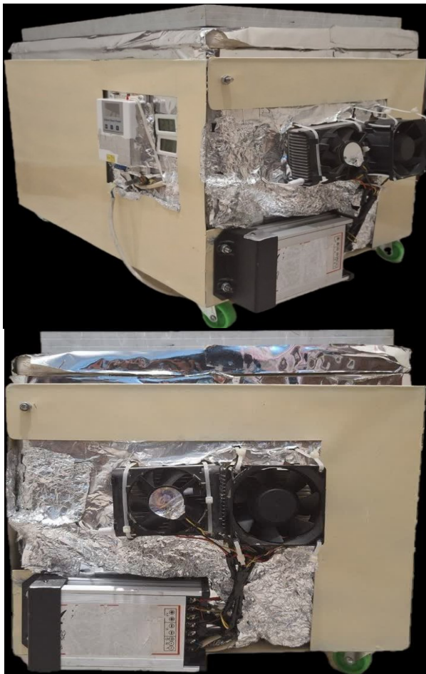
شکل 7 سیم‌کشی و اتصال اجزای الکتریکی یخچال
