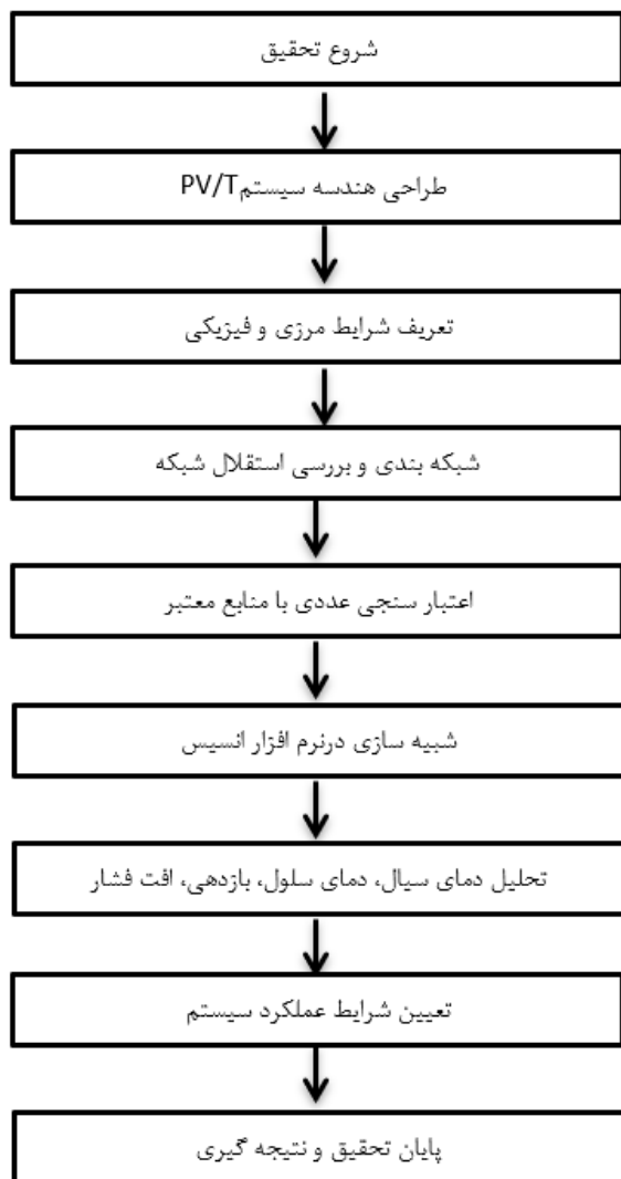
شکل 1 الگوریتم بررسی عددی تأثیر نانو سیال در عملکرد حرارتی و الکتریکی سلول‌های خورشیدی
