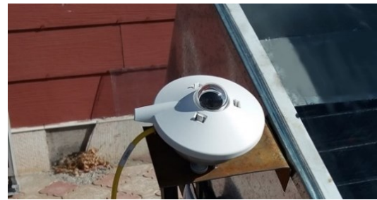
شکل 3 عکس پیرانومتر کیپ -اند-زونن مدل CMP3 نصب شده بر روی دستگاه
