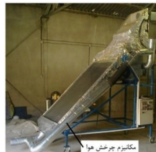
شکل 8 خشک‌کن خورشیدی مجهز به مکانیزم بازیافت حرارتی مستقیم [17]
