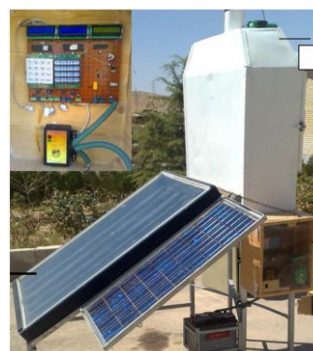
شکل 6 خشک‌کن خورشیدی فعال غیرمستقیم با کنترلر دور فن هوای ورودی [21]
