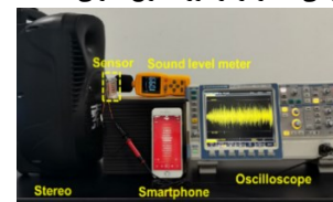
شکل 19 نمایی از تبدیل انرژی صوتی به انرژی الکتریکی توسط TENG [61].
