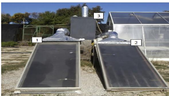
شکل ۹ خشک کن غیرمستقیم خورشیدی: (۱) ذخیره کننده انرژی خورشیدی، (۲) پنل هوای خورشیدی، (۳) اتاق خشک کن [۳۹].
