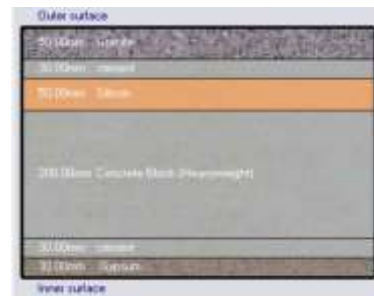
شکل 8 شبیه سازی ساختمان با مصالح نوع 4
