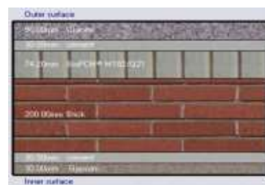
شکل 9 شبیه سازی ساختمان با مصالح نوع 5
