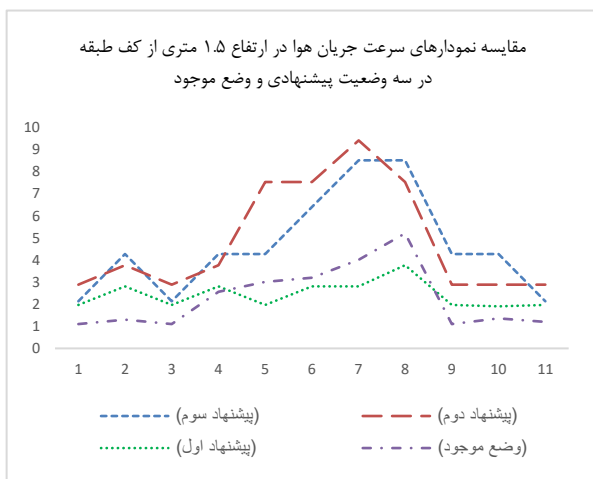
شکل 16 نمودار برش سرعت جریان هوا در سه وضعیت پیشنهادی و وضع موجود
