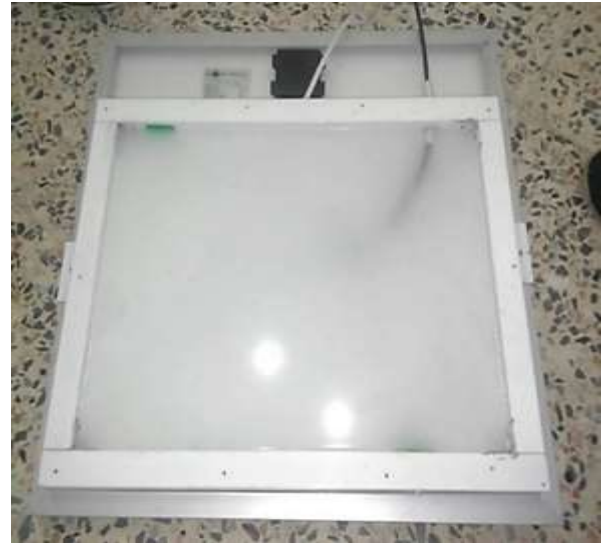
شکل 2 تصویری از پشت پنل فتوولتائیک مورد استفاده به همراه ماده تغییر فاز دهنده ی پشت آن
