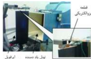
شکل 12 ستاپ آزمایشگاهی برداشت کننده مبتنی بر فلاتر [68]
