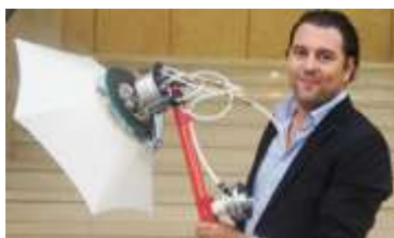
شکل 3 نمونه اولیه ساخته شده از توربین سافونیان [46]
