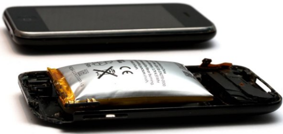
شکل 4 متورم شدن باتری لیتیوم-یونی یک تلفن هوشمند بر اثر تولید گاز درون باتری [46]
