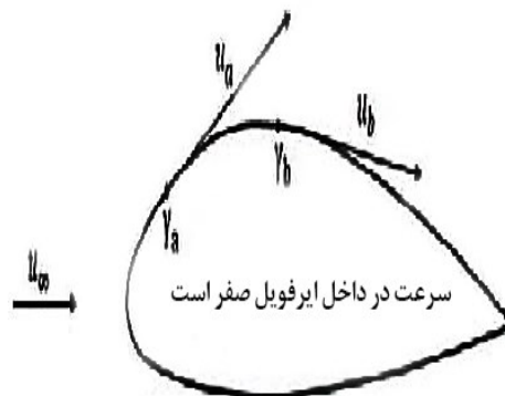
شکل 3 ایرفویل به صورت یک جسم صلب، با سرعت صفر در داخل مقعر
