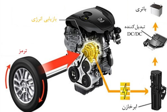
شکل 9 سیستم ترمز احیا شونده خودروی مزدا.
