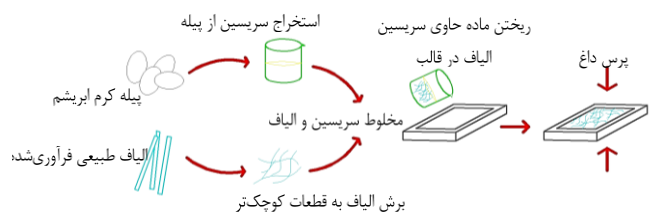
شکل ۲ روش تولید کامپوزیت نفاخته الیاف طبیعی و سربسین
