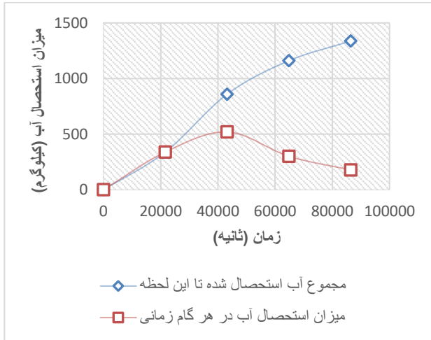
شکل ۵ نمودار میزان استحصال آب در کوپل خنک کن
