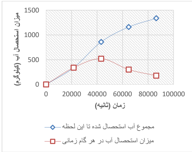
شکل ۵ نمودار میزان استحصال آب در کویل خنک کن
