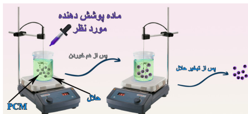
شکل ۱۰ شماتیک فرایند تبخیر حلال
