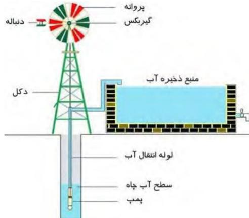
شکل ۳ سیستم بادی تأمین نیروی محرکه برای پمپ آب [۴۶]
