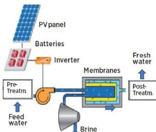
شکل ۱ سیستم نمک‌زدایی اسمز معکوس در ترکیب با سیستم تأمین انرژی فتوولتایک [۱۶]
