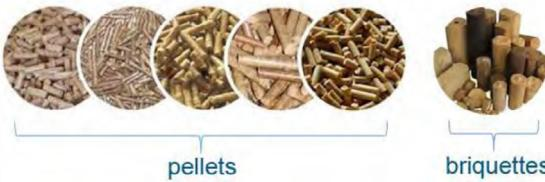
شکل ۵ سوخت جامد بریکت (سمت راست) و سوخت جامد پلت (چپ) [۶۰]
