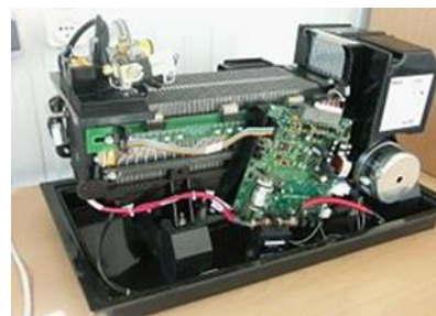
شکل ۷ پیل سوختی ۱/۲ کیلووات استفاده شده در نیروگاه طالقان [۵۵]
