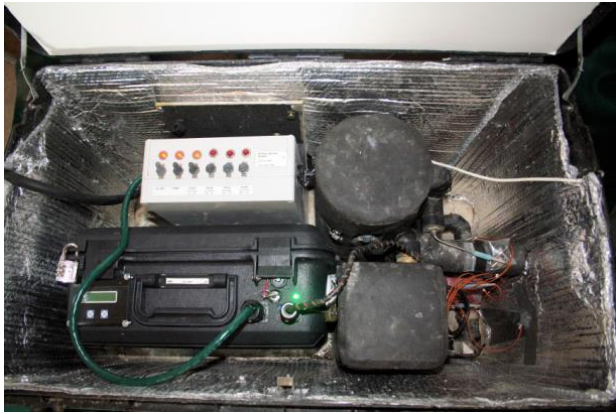
شکل ۲ واحد سیار مورد استفاده برای بررسی پاسخ حرارتی در سایت آزمون [۱۶]
