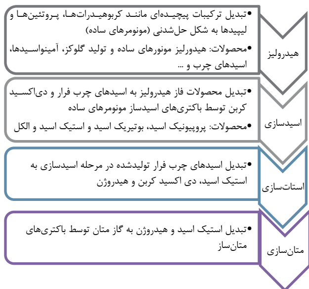
شکل ۸ فرایند هضم بیهوازی و تولید گاز متان [۶،۱۰]
