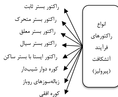
شکل ۷ انواع راکتورهای فرایند آتشکافت [۶]
