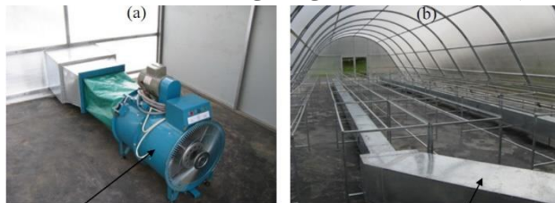
شکل ۱۱ خشک‌کن سهموی با (a) مشعل LPG و (b) کانال هوای
