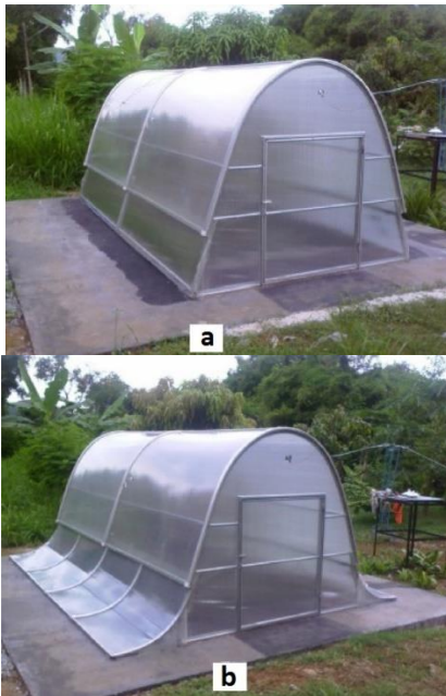
شکل ۶ خشک‌کن گلخانه‌ای (a) سهموی و (b) سهموی با باله‌های تقویت‌شده
