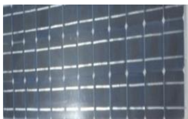
شکل ۱۰ پنل استفاده شده برای مقایسه اثر گرد و غبار، شن و ماسه بر خروجی پنل فتوولتاییک
