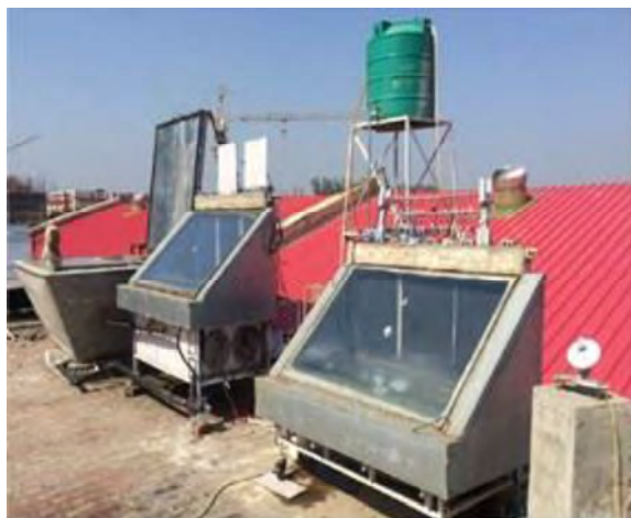
شکل ۱۳ استفاده از استخر خورشیدی همراه با رفلکتور تخت [۱۳]
