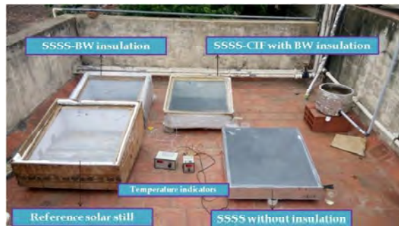
شکل ۳ استفاده از فوم اشباع کربن و همچنین عایق بندی با بابل رپ [۳]
