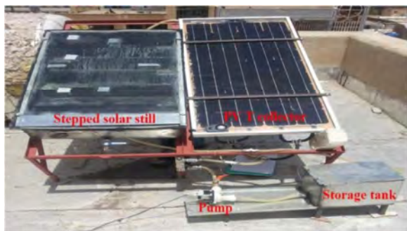
شکل ۵ استفاده از کلکتور PVT جهت پیش گرم کردن آب ورودی دستگاه [۵]
