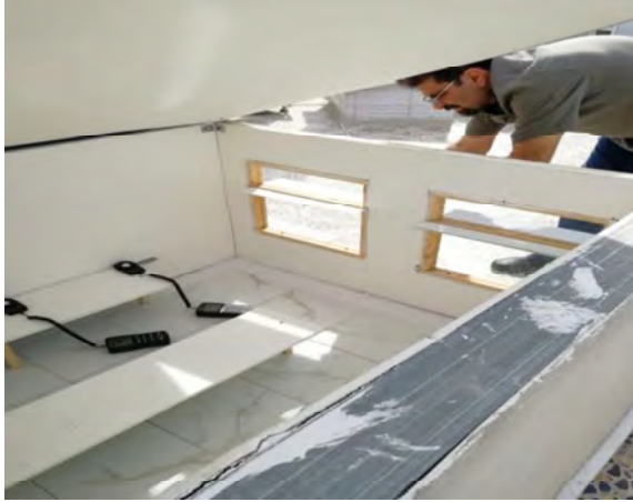
تصویر ۸ آزمایش شدت نور با طاقچه داخلی و خارجی
