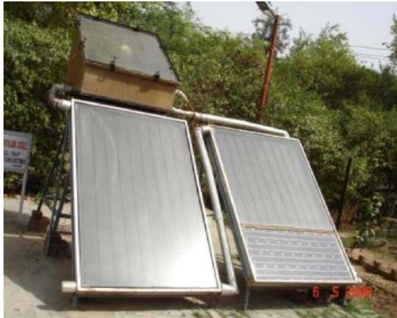
شکل ۱۸ آب شیرین کن فعال فتوولتائیک [۷۰]
