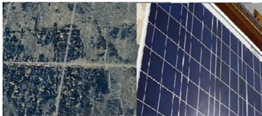
شکل ۷ پنل خورشیدی قرار گرفته در معرض گرد و غبار بعد از ۳۰ روز
