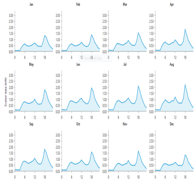
شکل ۴. شبیه سازی بار مصرفی یک خانه با نرم افزار HOMER
