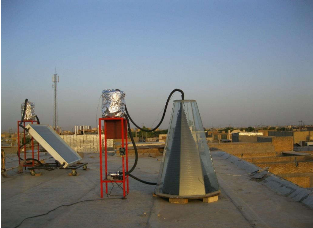
شکل ۲ عکس واقعی از کلکتورهای خورشیدی در حین آزمایش
