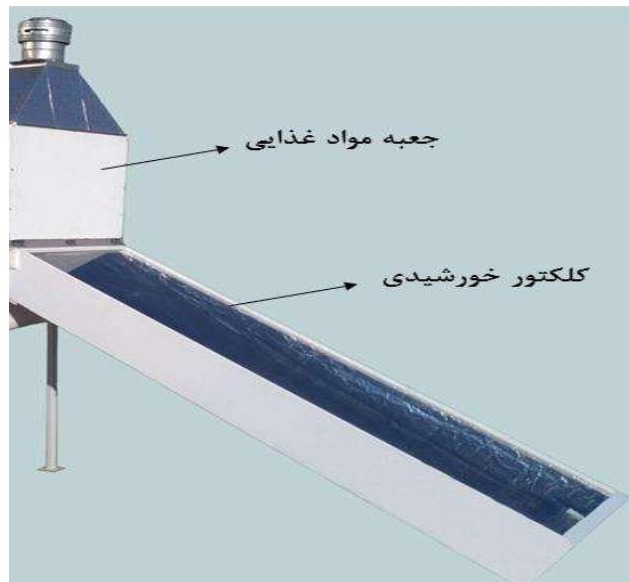
شکل ۱ شماتیک خشک کن خورشیدی
