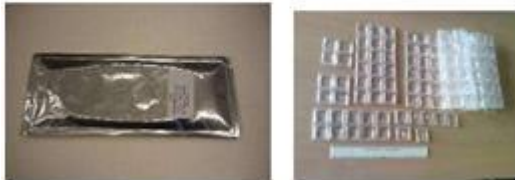
شکل ۵ مواد تغییر فاز دهنده ذخیره شده در قالب شکل‌پذیر [۷]
