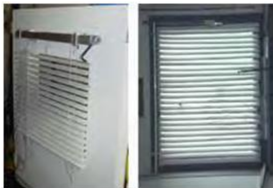
شکل ۱۱ کرکره‌های حاوی مواد تغییر فاز دهنده [۹]
