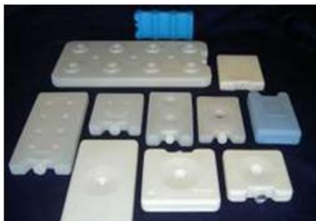
شکل ۵ مواد تغییر فاز دهنده ذخیره شده در قالب شکل‌پذیر [۷]
