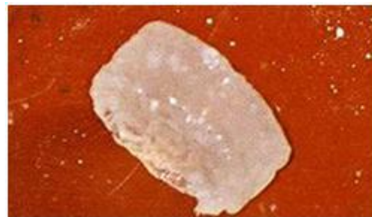
شکل ۴ مواد تغییر فاز دهنده با حالت خمیری [۷]
