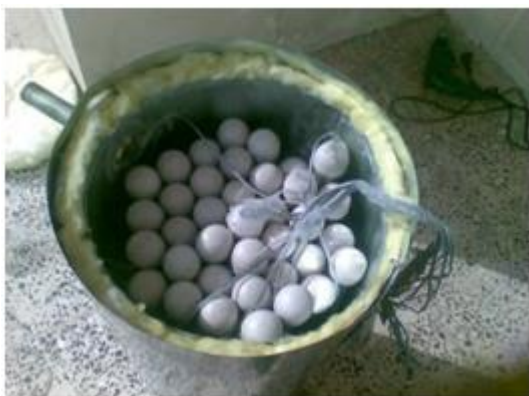
شکل ۱۷ نمایی از مخزن ذخیره حاوی مواد تغییر فاز دهنده
