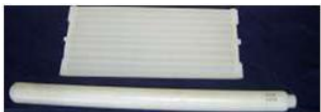
شکل ۶ مواد تغییر فاز دهنده ذخیره شده در قالب پلاستیکی [۷]
