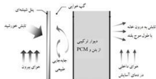
شکل ۸ نمایی از نحوه عملکرد دیوار ترومب [۸]
