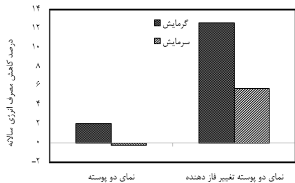
شکل ۱۰ مقایسه درصد کاهش میزان مصرف انرژی سالانه با استفاده از نمای دوپوسته تغییر فاز دهنده در بندرعباس
