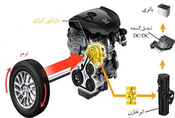
شکل 9 سیستم ترمز احیا شونده خودروی مزدا.
