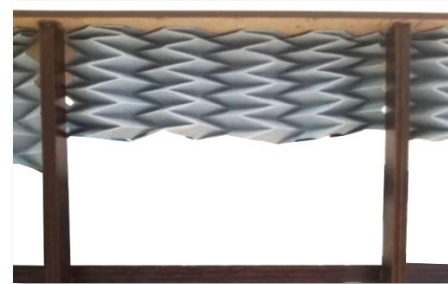
شکل ۱۳ ماکت برای مدل‌سازی نمای متحرک با استفاده از الگوی اورینگامی
